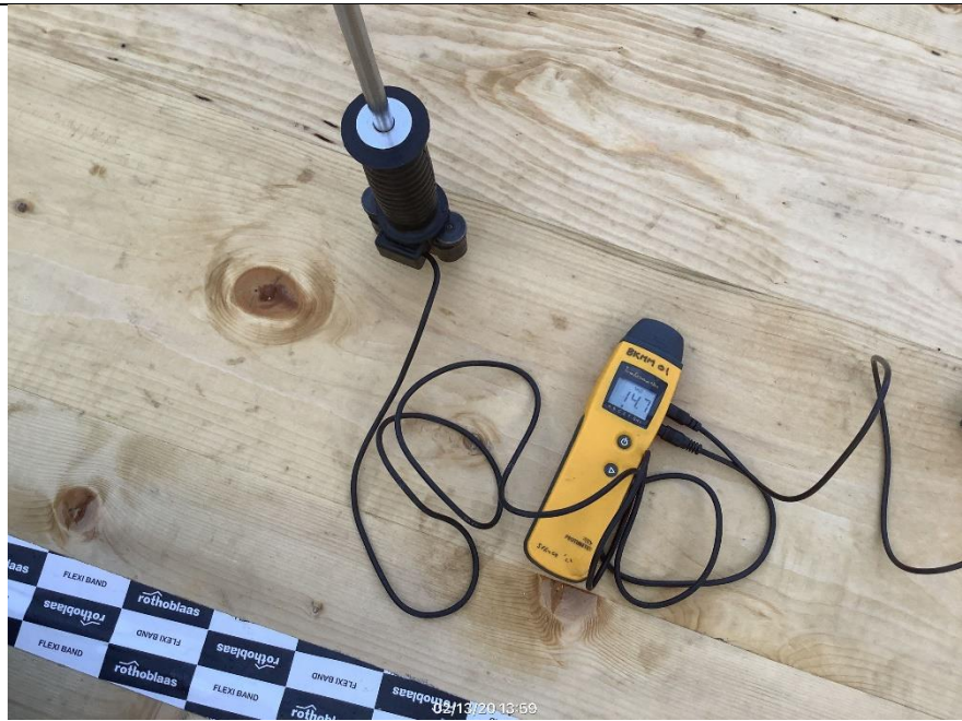
CLT moisture checks
